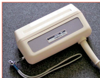
圖 1 農業科技研究所於 105 年度經行政院農業委員會補助，購入超音波掃描儀 ALOKA Prosound 2 (Hitachi Aloka Medical, Ltd., Tokyo, Japan;左圖)，並於今 (106) 年度購入長度為 12.5 公分的 3.5 MHz 探頭 (型號:UST-5011- 3.5;Hitachi Aloka Medical, Ltd., Tokyo, Japan;右圖) (圖片來源: http://www.hittecmedical.com/116/ecografo-ALOKA-ProSound-2.html ; http://www.hittecmedical.com/142/transductor-veterinario.html )。
